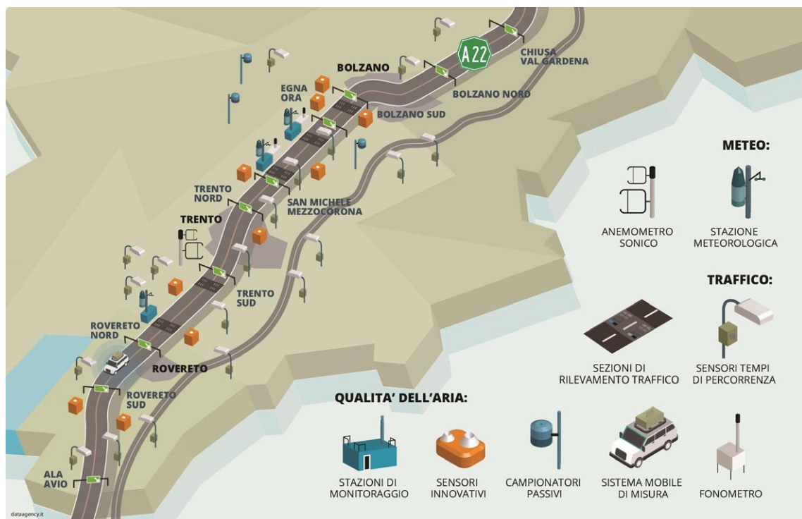
Figura 1: I sistemi di monitoraggio del progetto BrennerLEC
